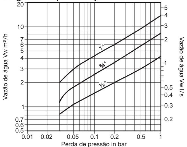
Diagrama de perda de pressão com a válvula aberta a 20°C. Os valores indicados são aplicáveis à válvulas atuada por mola com fluxo horizontal. Com fluxo vertical, desvios insignificantes ocorrem somente dentro do range de abertura parcial. As curvas dadas no gráfico são válidas para água a 20°C. Para determinar a queda de pressão para outros fluidos, o volume de vazão de água equivalente deve ser calculado e usado no gráfico.
